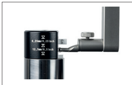
Obr. 13 Nastavení polohy nastavovacího bloku při kalibraci na drážce
